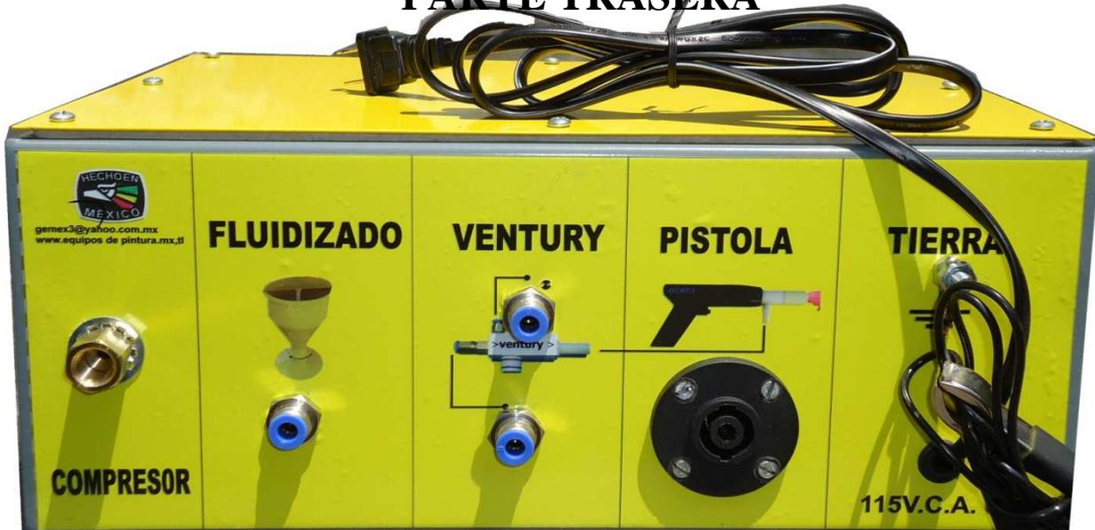
**Equipo rotulado con indicaciones de conexiones
