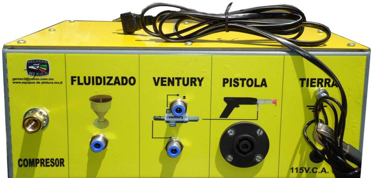
**Equipo rotulado con indicaciones de conexiones
